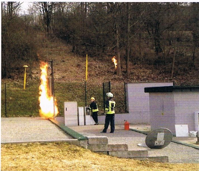
Die notwendigen Abmessungen von ausreichend großen Ex-Bereichen werden häufig unterschätzt. Anlässlich der Veranstaltung „Löschen von Gasbränden“ beim DVGW-Bildungszentrum in Rohr, Thüringen, wurden Tests durchgeführt und videografiert. Die Aufnahmen zeigen, wie großflächig sich die Flamentwicklung ausbreiten kann.
